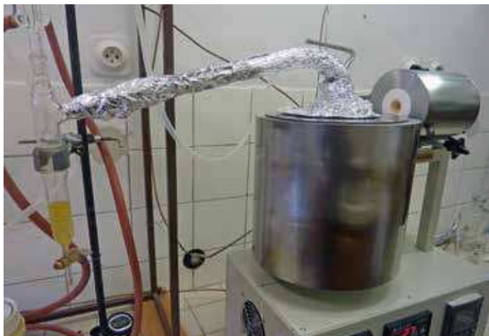
Príprava tekutého depolymerizátu pyrolýzou
