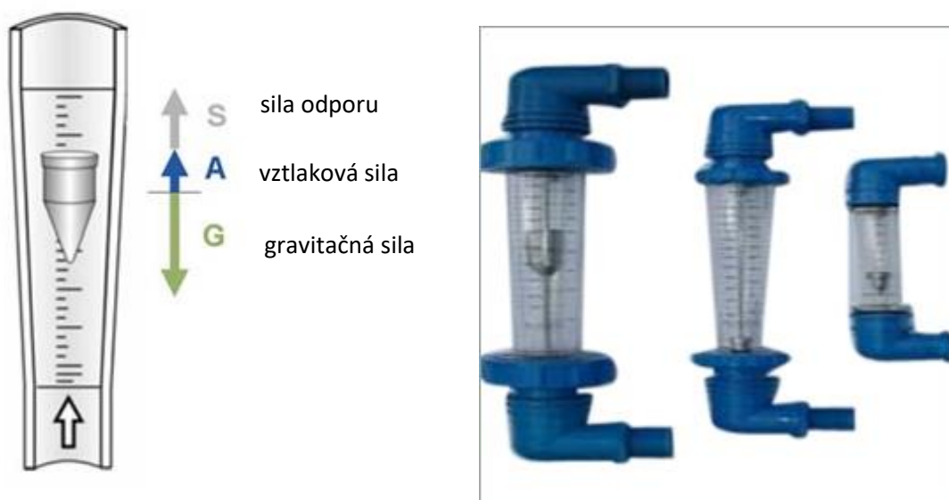
Obr. 3.5. Schéma rotametru s vyznačením síl pôsobiach na plavák a príklad reálneho zariadenia.
