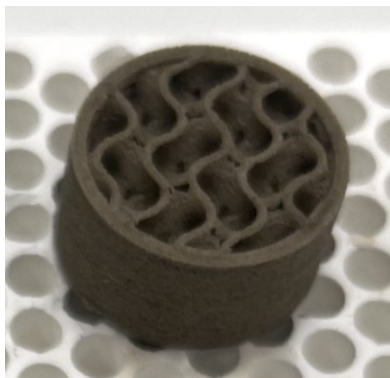
Obr. 2) Vytlačená vzorka s výplňou „gyroid“ s rozmermi 20 × 20 × 20 mm
