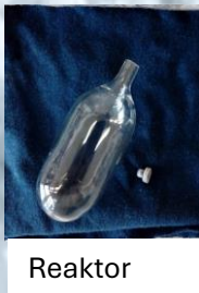
Aparatúra na oxidačné testy s kovovým reaktorom so sklenenou vložkou a detekciou spotreby kyslíka
