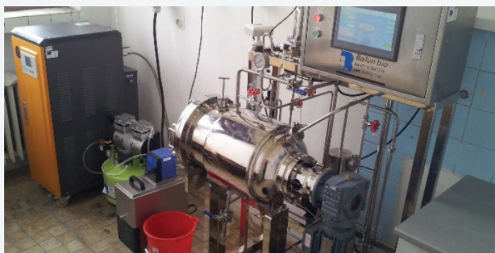
Poloprevádzkové laboratórium polosuchých fermentácií (fermentor BLBIO-30SS s príslušenstvom)
