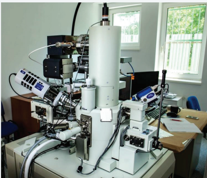
Elektrónový skenovací mikroskop JEOL 7500F
